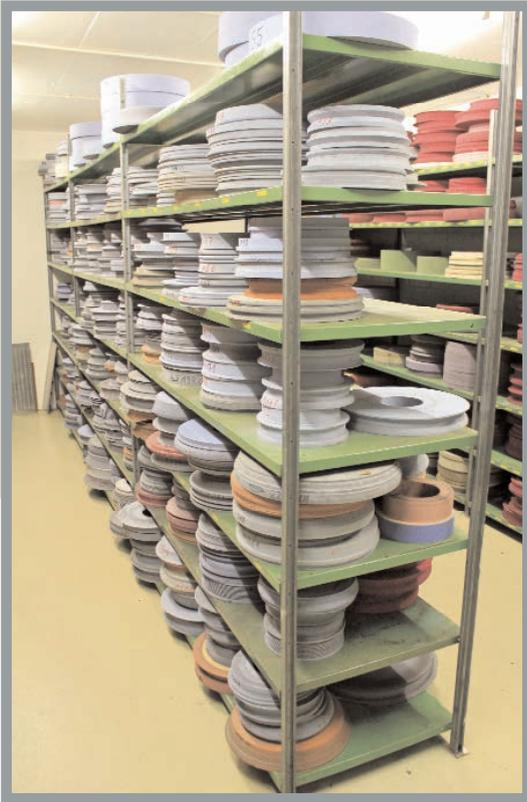
**Bild 2. Das Lager für Schleifscheiben enthält Rohlinge sowie fertig profilierte Schleifscheiben in zahllosen Varianten**
