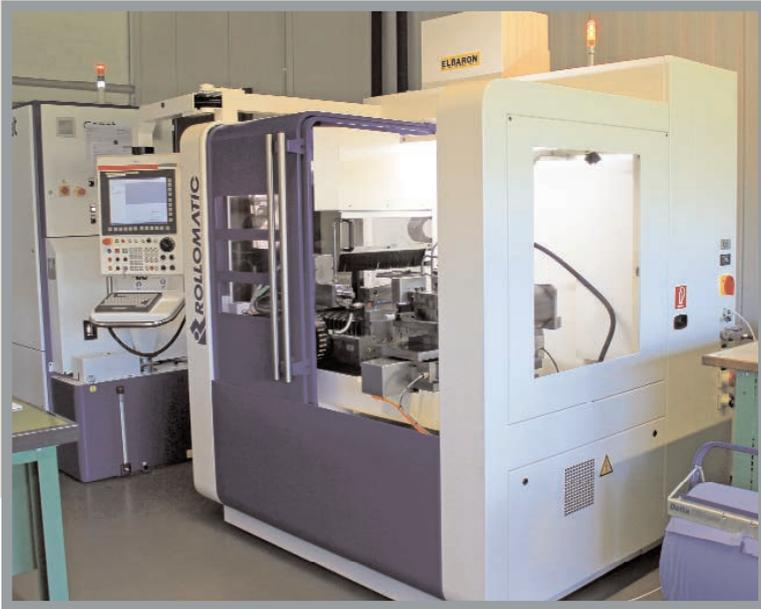
**Bild 5.** Die Schäl Schleifanlage von Rollomatic kann selbst extrem dünne und zugleich lange Teile mit hoher Genauigkeit und Oberflächengüte herstellen
